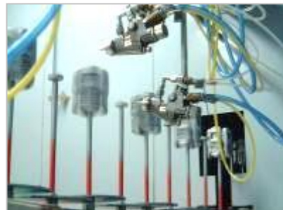
車載部品・ドア・ライト等の塗装 (小物・回転方式)
