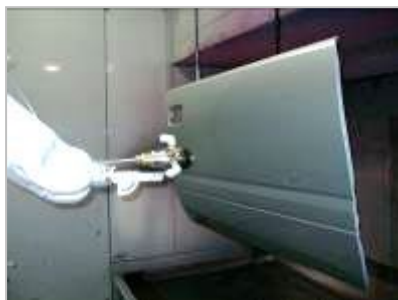
車ボディ・バンパー等の塗装 （中物・コンベヤ方式等）
